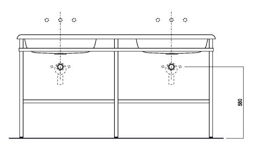
Scarico per sifone a bottiglia e per sifone ad incasso (.PLA0456 + AKIT0731) Drain for bottle trap and for concealed waste trap (.PLA0456 + AKIT0731)
